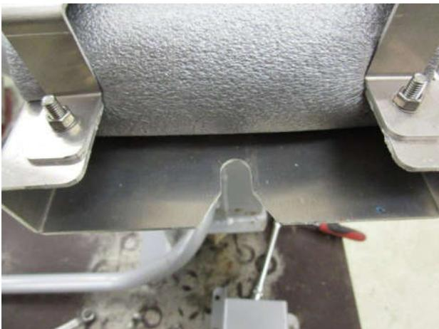
6. Schieben sie nun die fertige Akkuhalterung in das PPU-Gehäuse zurück. Bitte beachten sie, das die Aussparung an der Halterung unter den Schraubenkopf im Gehäuseboden faßt.
