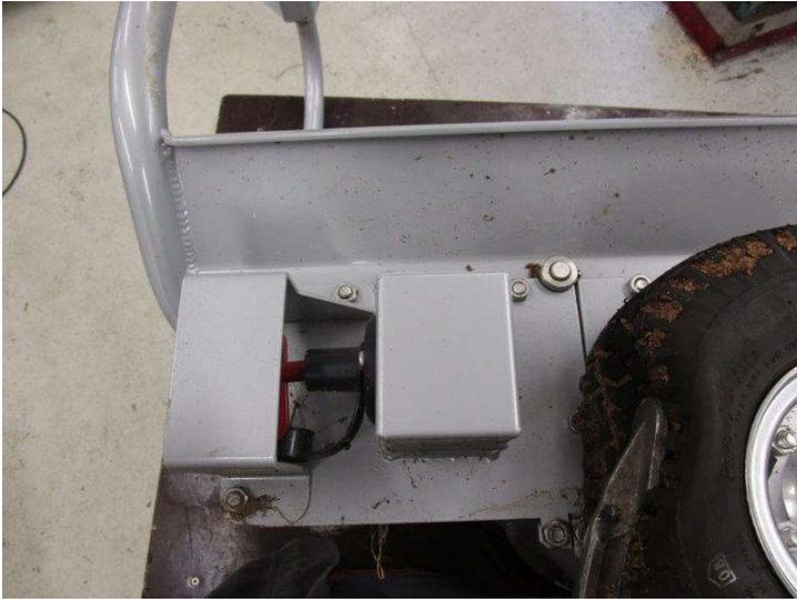
**3.** Lösen und entfernen sie die Sechskantmuttern der Abdeckung. Anschließend entfernen sie die Abdeckung. Die Abdeckung ist eingedichtet und läßt sich mit einem entsprechenden Hebelwerkzeug lösen. Entfernen sie nun die Dichtmittelreste.
