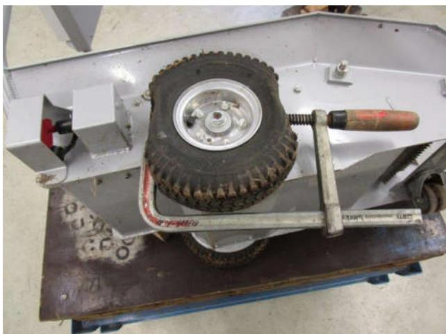
2. Öffnen sie das Reifenventil und lassen sie die Luft entweichen. Anschließend drücken sie den Reifen mit einer Schraubzwinde soweit zusammen, dass genug Platz entsteht, um die seitliche Abdeckung mit dem „Main-Switch Battery“ zu entfernen.
